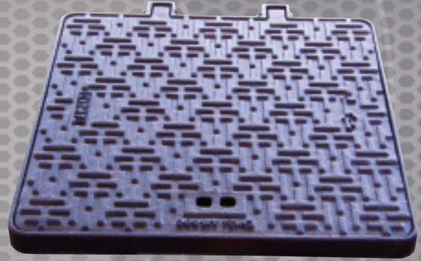
غطاء غرفه نفثيش موديل حرفه T مقاس داخلى 60 × 60 مع حمل إختبار 20 / 40 طن من الزهر المرن
