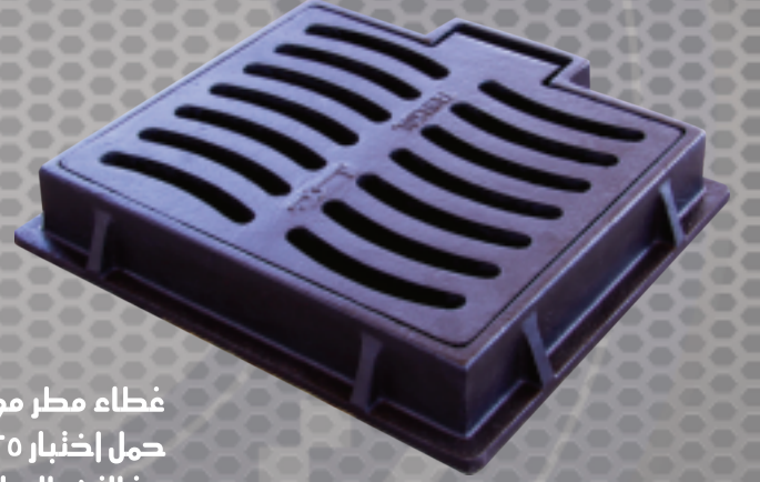
غطاء مطر موديل رمسيس بمفصلات مقاس ٤٠٠ × ٤٠٠ مع بمانع أتربة حمل إختبار ٤٠ طن من الزهر المرن
