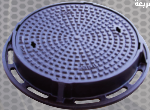
غطاء صرف صحي موديل القاهرة قطر داخلي ٥٠٠ مم حمل اختبار ٤٠ طن من الزهر الرمادي
