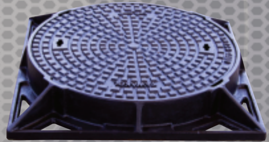
غطاء صرف صحي موديل القاهرة قطر داخلي ٥٥٠ مم حمل اختبار ٤٠ طن من الزهر الرمادي
