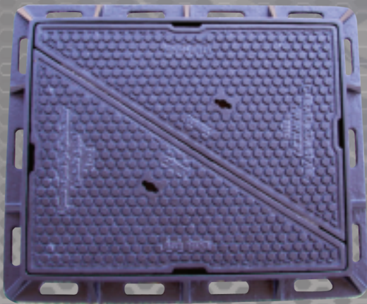
غطاء ٢ طبقة مثلية مقاس داخلي ٧٠٠ × ٧٠٠ مع حمل اختبار ٤٠ طن من الزهر المرن
