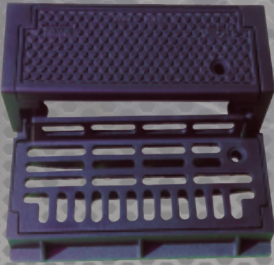
غطاء صرف مياه الأمطار للريفيه بمفصلة و قفل حمل إختبار ٢٥ طن من الزهر المرن مقاس خارجي ٢٠ × ٨٩ × ٦٥ سم
